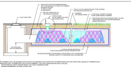
**CULTEC RECHARGER 360HD HEAVY DUTY TYPICAL INTERLOCK**
